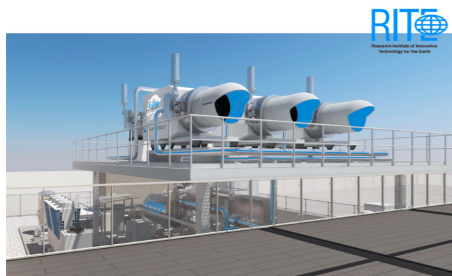
提供RITE)：大阪・関西万博で二酸化炭素を回収する装置のイメージ画像
